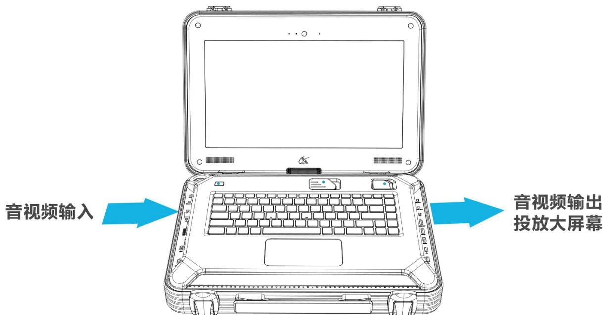
**机身左侧（输入）接口。**连接转写机输入接口，可以把另一台设备的音视频信号输入到转写机。转写机可对输入的声音和视频进行语音转文字和字幕处理。
